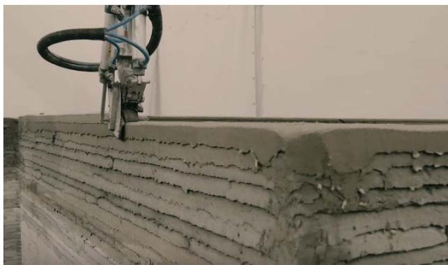
Рисунок 2. Строительный 3D принтер объемной печати
